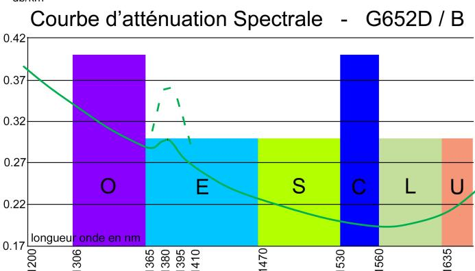
La fibre G652 D supporte les applications de multiplexage actuelles (WDM : Wavelength Division Multiplexing) utilisant les bandes C et L et des débits de transmission supérieurs au térabit/s.La fibre G652 D dont le pic OH- a été réduit (courbe verte ci- dessus), voire supprimé, permet l'utilisation de la bande E contrairement à la G652B.
