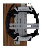
Ce dispositif fixe et protège des boucles de loves de blocage des câbles à fibres optiques aériens. Son usage est recommandé à proximité d'un boîtier d'épissure lorsqu'un câble aérien est déployé sur une longueur de plus de 200 mètres, ou dans les zones à risque climatique de 1 kg de givre par mètre de câble ou plus. Le corps est constitué de deux demicorps coulissants qui s'ajustent au diamètre de boucles de love souhaité.
